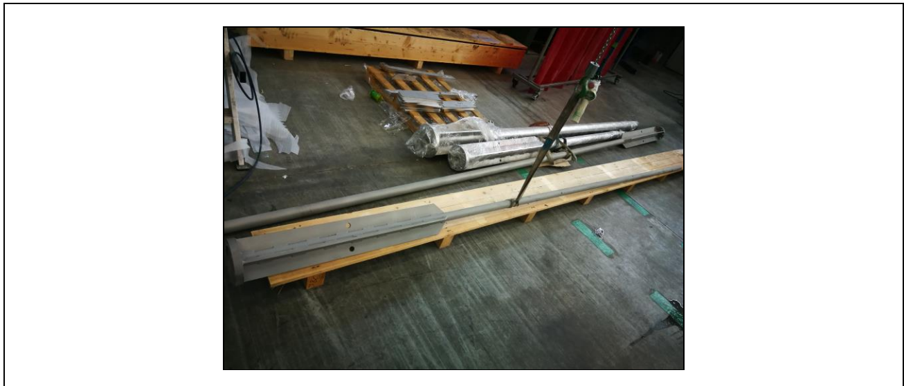
Afbeelding 4-5 Verplaatsing door middel van vastsnoren aan het zwaartepunt van het stuk
