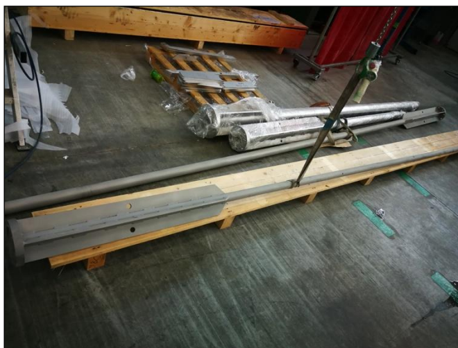
Изображение 4-5 Перемещение посредством обвязывания по центру тяжести детали
