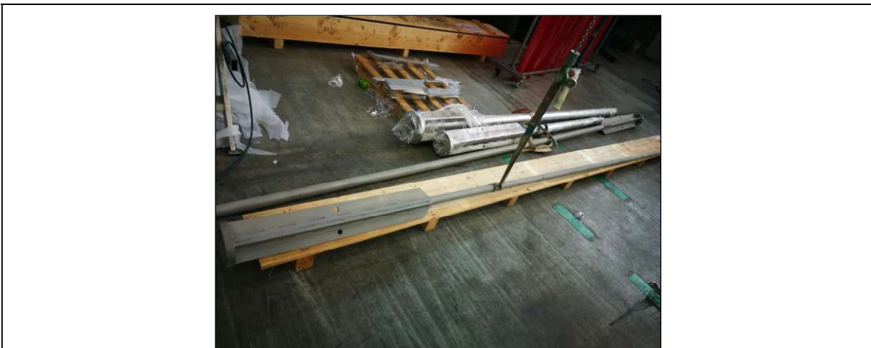
Rysunek 4-5 Przemieszczanie poprzez zawieszenie do środka ciężkości części
