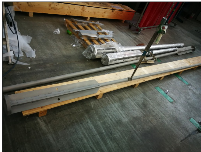
Slika 4-7 Premještanje pomoću pojasa u težištu komada
